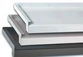
Alle Wohnraumfenster erhalten Außen-Fensterbänke aus **einbrenn-lackiertem Aluminiumprofil** mit passenden Endkappen und einer Anti-Dröhn-Beschichtung auf der Unterseite. Die Alu-Bänke werden durch den Fassadenbauer in das WDVS-System integriert. Als Farbvorlage dienen die Fensteranlagen.
